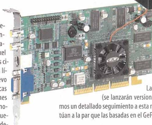
de 165 Mhz y la decodificación HTDV entre otras cosas. La compañía se ha destacado desde hace tiempo en la integración de muy buenos soportes para DVD, y esto se ha mejorado en las tarjetas basadas en Radeon 256. Además va a poder conectarse con pantallas planas digitales a resoluciones de 1600 x 1200. ¿Podrá ATI relevar de su trono a la últimamente inamovible Nvidia?
